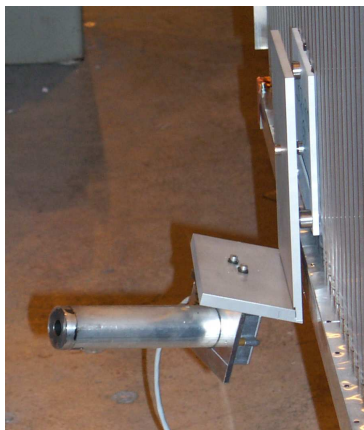
FIG. 13 – Caméra du système de référence fixée sur une chambre
